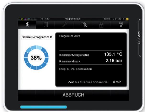
So übersichtlich und komfortabel wird der Sterilisationsverlauf angezeigt
